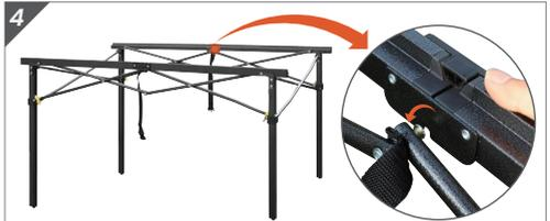
4 Identifizieren Sie die Kerben in den Rahmenbalken und die hervorstehenden Niete in den Querstrebenröhren. Richten Sie die Kerbe in der Mitte des Rahmenbalkens mit der hervorstehenden Niete am Querrohr aus und schnappen Sie sie ein.
