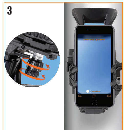
3. Zentrieren Sie dann Ihr Smartphone über dem Spiegel des StarSense-Docks. Drehen Sie die Knöpfe an der Unterseite der Halterung, bis die Kameraansicht Ihres Smartphones ungehindert im Spiegel zentriert ist.
