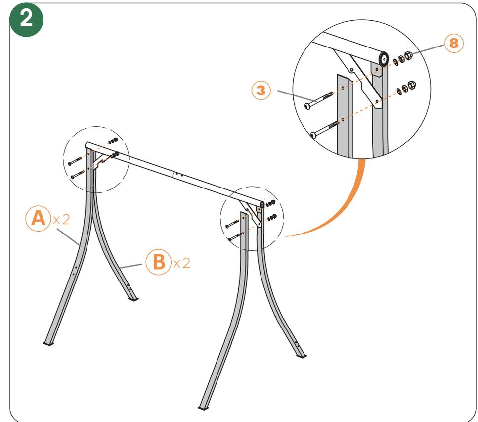
■ Befestigen Sie die Beine(vorn) #A und die Beine(hinten) #B durch M8\*75mm-Schraubensets(#3) und Muttern(#8) an den Balken #C, #D.
