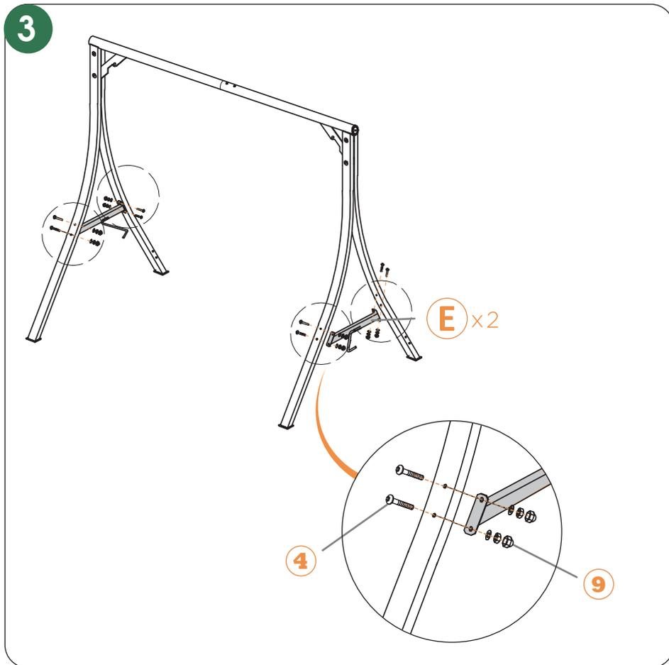
— Verbinden Sie die Beinstangen #E durch M6\*40mm-Schraubensets(4) und Muttern(9) mit den Beinen(vorn) #A und den Beinen(hinten) #B.
