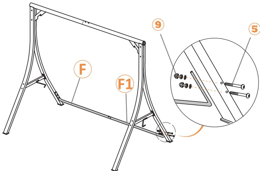
— Verbinden Sie die Rückenstange #F, #F1 durch M6\*35mm-Schraubenset(①) und Mutter(⑨) mit zwei Beinen(hinten) #B.
