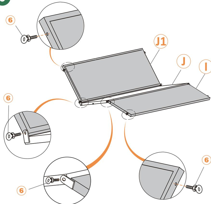
— Verbinden Sie die Sitzplatte #J durch M8\*20mm-Schrauben(⑥) mit der Rückenlehneplatte #J1 und der Beinplatte #I.
