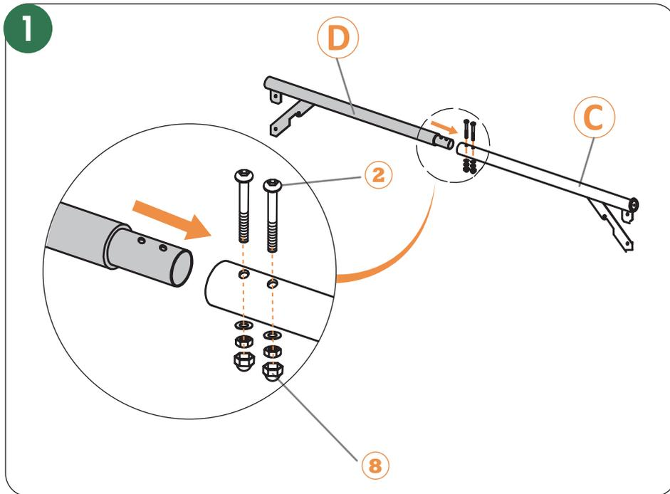
■ Verbinden Sie den Balken(links) #C durch M8\*60mm-Schraubensets(#2) und Muttern(#8) mit dem Balken(rechts) #D.
