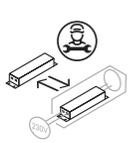
Upravljački uređaj može zamijeniti kvalificirani električar
