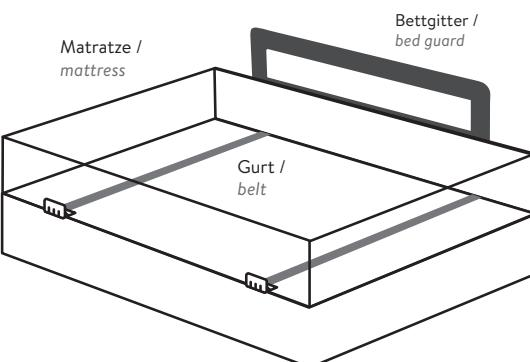
1) Vor der Positionierung unter der Matratze müssen Sie den T-Bügel um 90° drehen.
