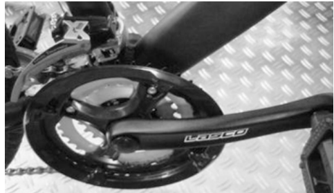
Kettingblad vooraan met derailleur
