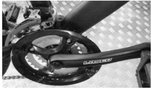
Front chain ring with derailleur
