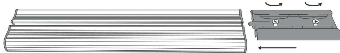
**Schritt 1:** Drehen Sie die Mutter der Schraube des Slide-In-Konnektors so weit ab, dass sich der Slide-In-Konnektor in die vorgesehene Leiste in der Mitte der LED-Leiste schieben lässt.
