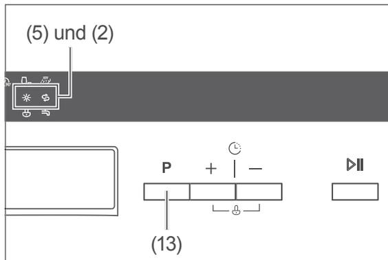
2. Halten Sie die Taste **P** (13) so lange gedrückt, bis die Anzeigen  $*$  (5) und  $\odot$  (2) abwechselnd blinken.
