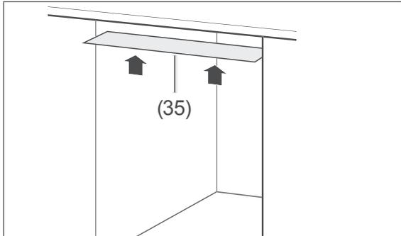
3. Kleben Sie die beiliegende Schutzfolie (35) auf die Unterseite der Arbeitsplatte. So vermeiden Sie Schäden an der Arbeitsplatte aufgrund heißer Dämpfe, die bei geöffneter Gerätetür aus dem Geschirrspüler strömen.
