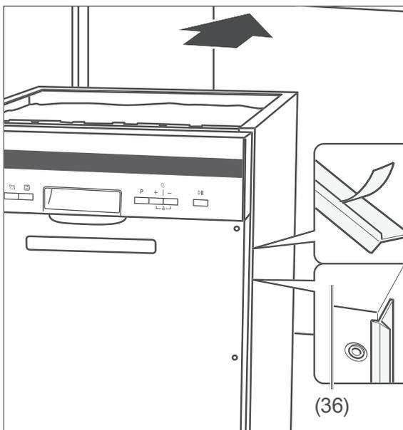
5. Entfernen Sie die Schutzfolien von den seitlichen Abschlussprofilen (36).
