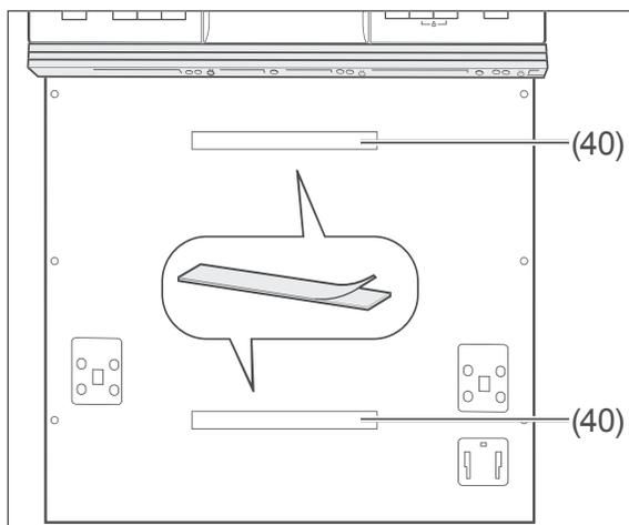
9. Kleben Sie die Klettbänder mit der abgezogenen Schutzfolie mittig auf die eingelassenen Bereiche auf der Gerätetür.
