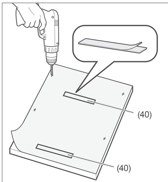
12. Legen Sie die mitgelieferte Bohrschablone so auf die Rückseite der Möbelfrontplatte, dass die Bohrschablone und die Möbelfrontplatte oben bündig abschließen.
