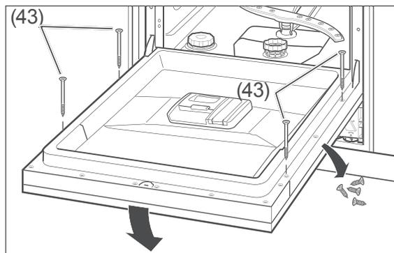
17. Entfernen Sie die 4 Schrauben an der Innenseite der Gerätetür. Schrauben Sie die Möbelfrontplatte an diesen Positionen mithilfe der beiliegenden 4 Schrauben (43) fest.
