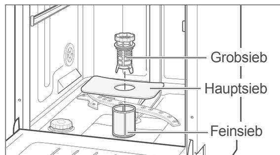
Überprüfen Sie nach jedem Spülgang das Grobsieb, das Hauptsieb und das Feinsieb, und entfernen Sie ggf. Speisereste und Fremdkörper:
