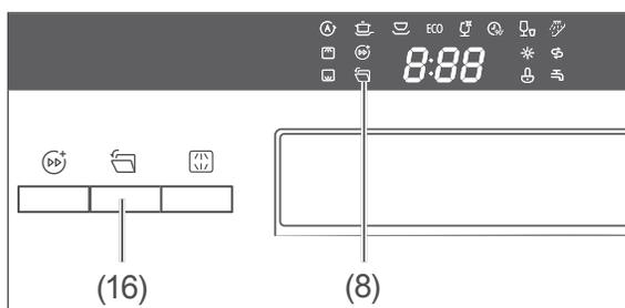
Standardmäßig ist die Funktion „Automatische Türöffnung“ aktiviert. Die Gerätetür öffnet sich während der Trocknungsphase des Spülprogramms automatisch und bleibt geöffnet.
