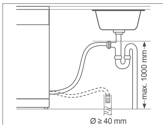
Sie können den Auslass des Ablaufschlauchs auf zwei verschiedene Weisen anschließen lassen:
