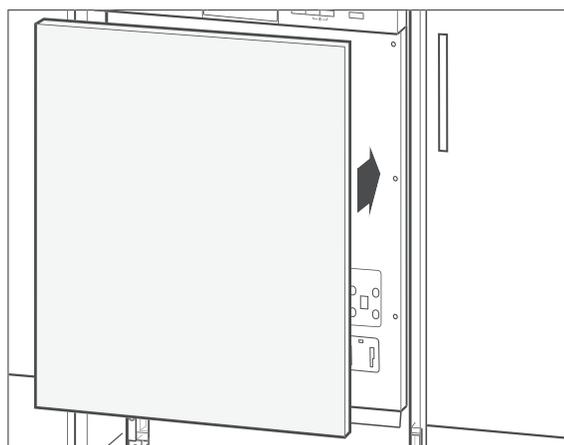
16. Fixieren Sie die Möbelfrontplatte mithilfe der Klettbänder (40) an der Gerätetür, halten Sie sie fest, und öffnen Sie vorsichtig die Gerätetür.
