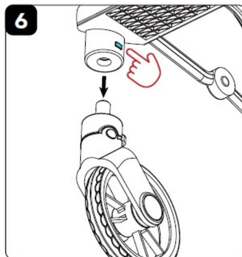
**Vorderräder montieren:** stecken Sie die Vorderräder vorne rechts und links in die Kunststofföffnung am Radkasten wie in Bild 5 gezeigt, bis diese einrasten.
