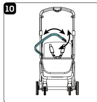
Stecken Sie den Spielbügel in die seitlichen Aussparungen auf beiden Seiten des Sitzes (Bild 8) und achten Sie darauf, dass der Stoßfänger einrastet. Sie sollten ein „Click“-Geräusch zur Bestätigung des Einrastvorganges hören.
