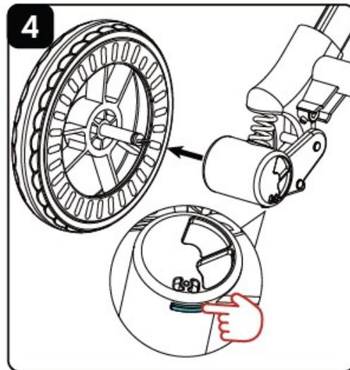
**Hinterräder montieren:** Stecken Sie die Hinterräder wie abgebildet (Bild 3) rechts und links in die dafür vorgesehenen Kunststofföffnungen der hinteren Achse, bis Sie ein „Click“-Geräusch hören, das den Verriegelungsvorgang bestätigt.
