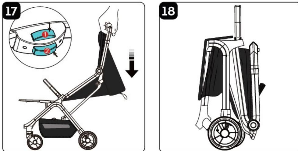
Halten Sie Knopf 1 und Knopf 2 am Griff gleichzeitig gedrückt und drücke Sie zur gleichen Zeit den Griff des Buggys nach unten: Der Buggy faltet sich so von selbst in die kleinstmögliche Position zusammen (Bild 18)
