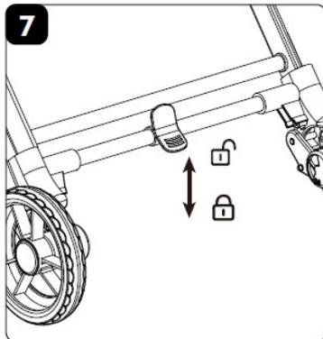
Treten Sie auf das Bremspedal, um die Bremse einrasten zu lassen und den Buggy sicher abzustellen.
