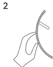
Entfernen Sie das Schutzpapier des Klettverschlusses.
