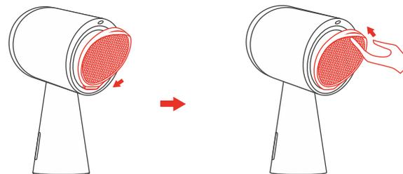
Befestigen Sie vor dem Gebrauch den Filter, indem Sie ihn unten am Lufteinlass einsetzen.
