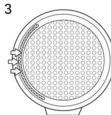
Befestigen Sie den Klettverschluss am Rand des Fettfilters.
