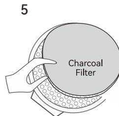
Befestigen Sie den Kohlefilter am Klettverschluss.
