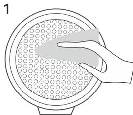
Reinigen Sie die Rückseite des Fettfilters und stellen Sie sicher, dass er trocken ist.
