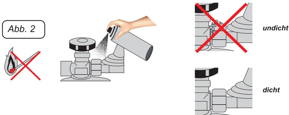
Nach jeder Montage des Druckreglers und immer dann, wenn es erforderlich ist, muss die folgende Dichtheitsprüfung durchgeführt werden:
