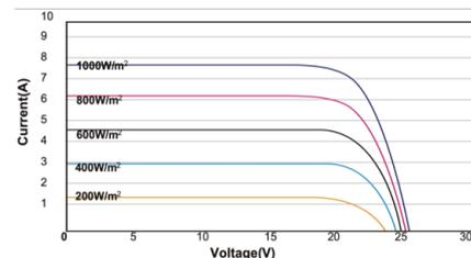
**PV-Kurven des PV-Moduls**
