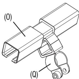
**Achtung: Verbinden Sie zuerst die Profile auf das fertig bestellte Maß und setzen Sie erst danach mit der weiteren Montage fort.**
