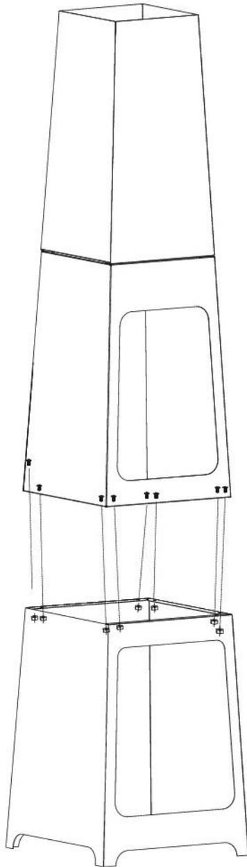
2. Montieren Sie das Unterteil (Bauteil 3) am vorab montierten Bauteil A+B mit den Schrauben "A" und den Muttern "B" gemäß der Zeichnung.
