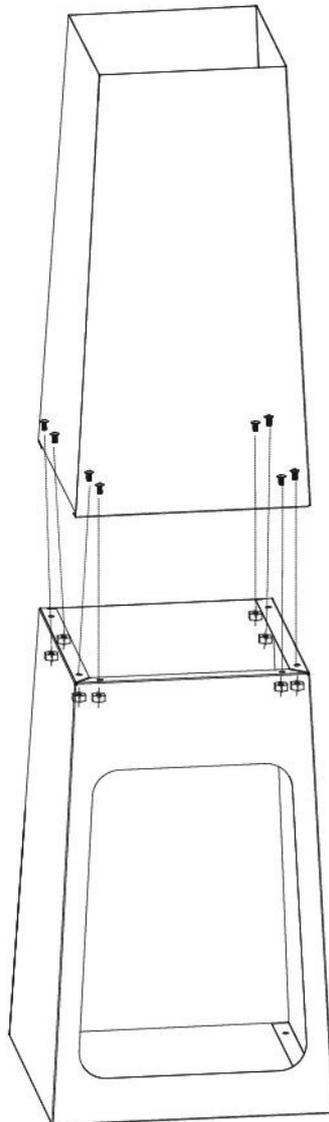
1. Verbinden Sie das Oberteil (Bauteil 1) mittels der Schrauben „A“ und der Muttern „B“ mit dem Mittelteil (Bauteil 2) gemäß der Abbildung.
