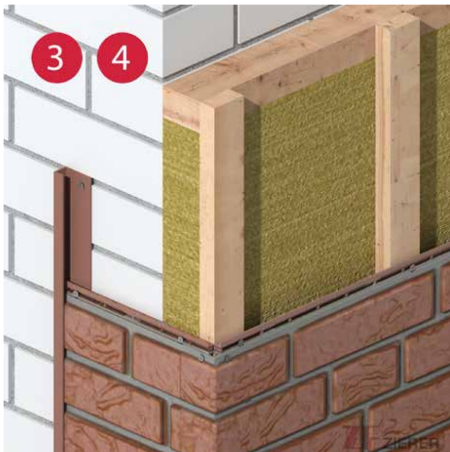
Original-Eckprofil in der Verwendung mit dem U-Profil zum Anschluss an eine nicht verkleidete Fläche.
