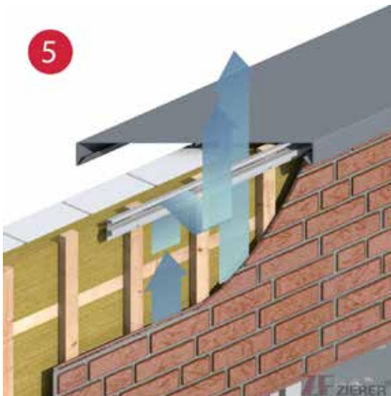
Oberer Abschluss zum Dachanschluss, Dachschräge (Entlüftung).
