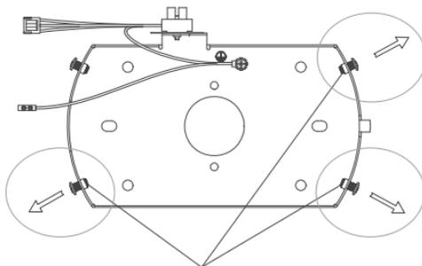
2. Wenn Sie die Deckenhalterung an einer Holzdecke installieren, befestigen Sie sie mit Holzschrauben und Unterlegscheiben an Holz oder Querbalken.
