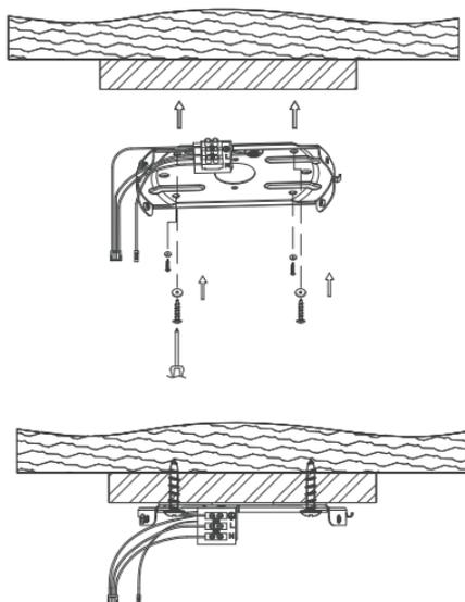
3. Bei der Montage an einer Betondecke bohren Sie zuerst mit einem 8-mm-Bohrer ein 50 mm tiefes Loch und befestigen Sie dann die Deckenhalterung mit den Dübeln an der Decke.
