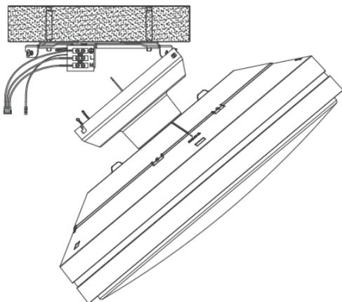
2. Schließen Sie die Kabel in der in der Zeichnung gezeigten Reihenfolge an, schließen Sie das Stromkabel an und setzen Sie die Steuerung in das Gerät ein.
