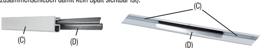
**Achtung:** Verbinden Sie zuerst die Profile mit den Profilverbindern und setzen Sie erst danach mit der weiteren Montage fort.
