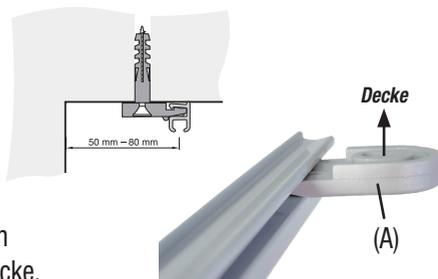
*Achten Sie darauf, dass die Deckenträger in einer Linie/Flucht montiert werden!*
