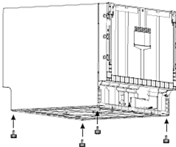
3. Setzen Sie das Gerät vorsichtig in die Einbauöffnung ein. Richten Sie die Standfüße des Gerätes auf dem Boden der Einbauöffnung aus (**A** /s. Abb. unten).
