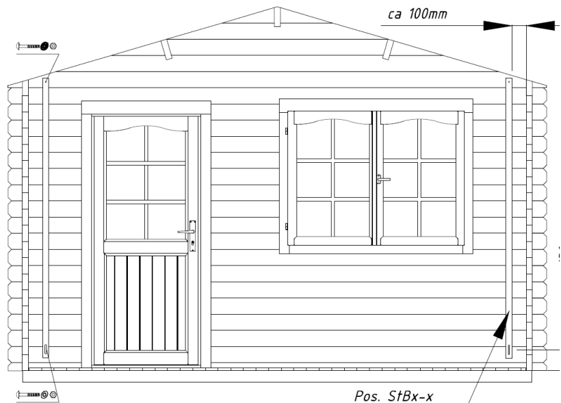
Installatie van de stormankers:
