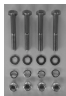
Tornillos de vástago hexagonal M8 x 55 Arandelas 15,8 x 8,5 x 1,1 Arandelas elásticas Tuerca M8
