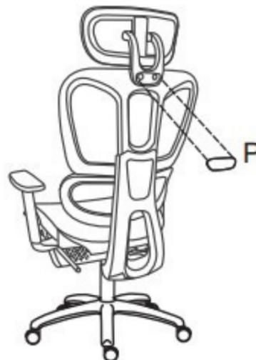
b. Setzen Sie die fertig montierte Rückenlehne und die Sitzfläche auf das Fußkreuz auf.
