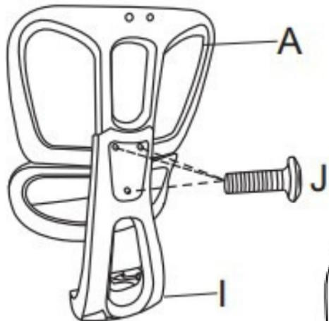
a. Montieren Sie die Befestigung (**I**) an der Rückenlehne (**A**) mit den dafür vorgesehenen Schrauben (**J**).
