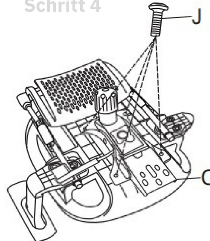
Befestigen Sie die Mechanik (**C**) am unteren Teil der Sitzfläche mit den Schrauben (**J**).
