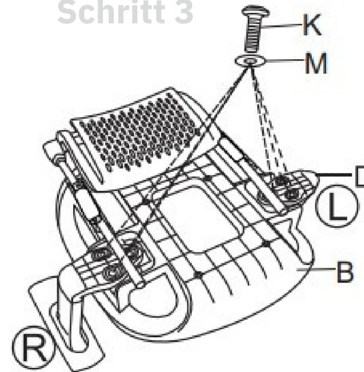
Befestigen Sie die beiden Armlehnen (**D**): die linke (**L**) und die rechte (**R**) an der Sitzfläche (**B**) mit den Unterlegscheiben (**M**) und den Schrauben (**K**).
