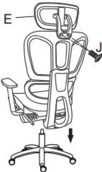
a. Montieren Sie die Kopfstütze (**E**) an der Rückenlehne mit den dafür vorgesehenen Schrauben (**J**).
