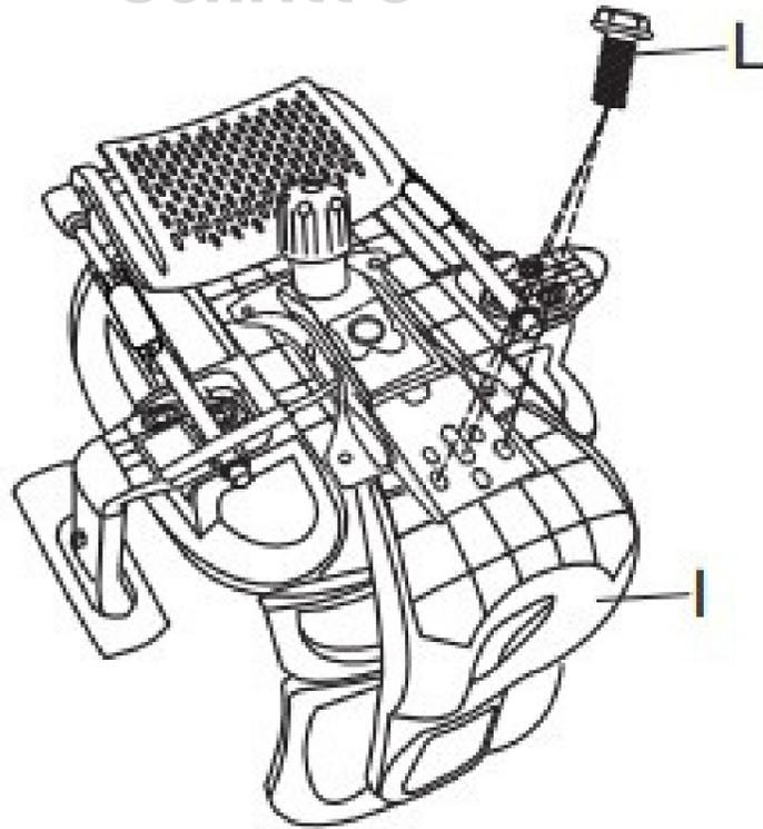
Verbinden Sie die Sitzfläche und die Rückenlehne mit der Befestigung (**I**) mit Hilfe von den Schrauben (**L**).
