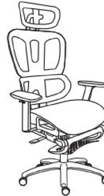
Setzen Sie sich nun mehrmals auf den Stuhl, damit die Verbindung zwischen Sitz, Gasfeder und Fuß gefestigt wird. Anschließend können Sie die Gasfeder bedienen und die Stuhlhöhe individuell einstellen.
