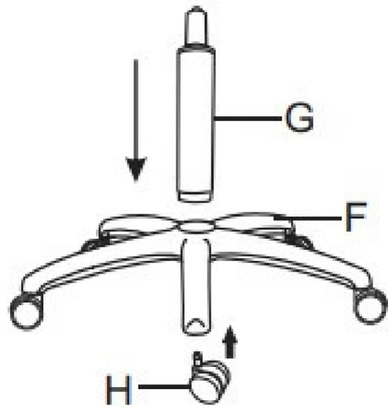
Drücken Sie die Rollen (**H**) in die fünf Öffnungen des Fußkreuzes (**F**).
