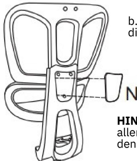
b. Anschließend verwenden Sie die Schutzabdeckung (**N**).
