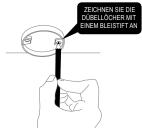
Benutzen Sie den Montagesockel, um die Dübellöcher an der Decke oder an der Wand zu
