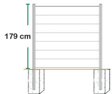
Der Pfosten kann mit einer für Aluminium geeigneten Kappsäge auf die benötigte Länge gekürzt werden.
