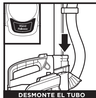
DESMONTE EL TUBO
