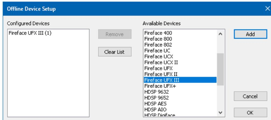
Setup: Gewünschte Geräte markieren und per Add zu der Liste der Configured Devices hinzufügen. Dialog per OK schließen.
