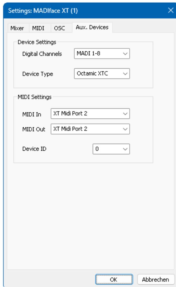
Bei der Nutzung mehrerer OctaMic XTC müssen diese unterschiedliche Device IDs besitzen (Konfiguration erfolgt im OctaMic XTC). Auch in *Aux Devices* lassen sich den 8-Kanal Blöcken verschiedene Device IDs zuweisen. Die Speicherung erfolgt sofort bei Auswahl einer Device ID. Die Prüfung der Zuweisungen erfolgt durch sequentielle Anwahl aller 8-Kanal Blöcke.
