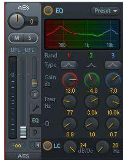
**Preset.** Einstellungen des Equalizers und des Low Cut können jederzeit gespeichert, geladen, und zwischen Kanälen kopiert werden. Ein Klick auf Preset öffnet ein Menü mit mehreren Unterpunkten:
