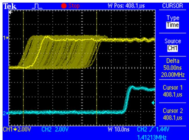
Das gesäuberte und von Jitter befreite Signal kann bedenkenlos in jeglicher Applikation als Referenz-Clock benutzt werden. Das von SteadyClock prozessierte Signal wird natürlich nicht nur intern benutzt, sondern ist auch an allen Ausgängen aktiv.
