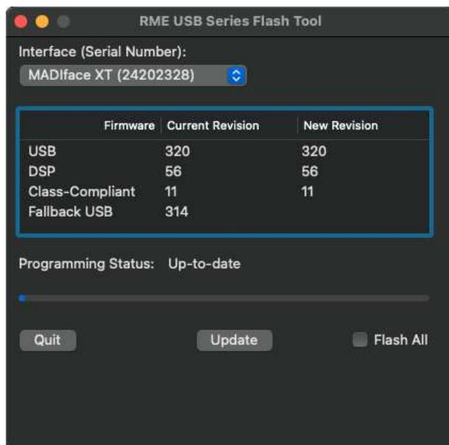
Sollte das Flashen fehlschlagen, wird ab dem nächsten Neustart ein im MADiface befindliches Not-BIOS benutzt. Das Gerät bleibt also funktionsfähig. Das Flashen sollte dann erneut versucht werden.
