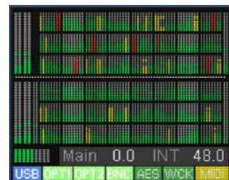
Darunter folgt die aktuelle Auslastung des DSP, der Volumewert von Main Out oder Phones, der Clock Status und die aktuelle Samplefrequenz.
