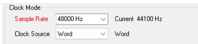
Unter ASIO setzt die Audiosoftware die Sample Rate selbst, so dass dieser Fehl-Zustand normalerweise nicht auftreten kann – in der Praxis aber doch. Denn Im Slave-Mode hat die externe Samplefrequenz Priorität. Ein Eingangssignal mit 44.1 kHz verhindert die Umschaltung der ASIO Software zu 48 kHz – offensichtlich, denn der einzige Weg dies zu tun wäre ein anderer Clock Mode (Master/Internal).
