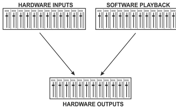
TotalMix kann in der obigen Ansicht (View Options **2 Rows**) platzsparend arbeiten. Default ist jedoch eine vertikale Anordnung wie bei einer Inline-Konsole, wobei die Reihe *Software Playback* dem *Tape Return* eines realen Mischpultes entspricht:
