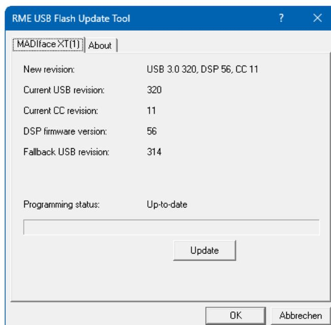
Sollte das Flashen unerwartet fehlschlagen wird ab dem nächsten Neustart das Not-BIOS des Gerätes benutzt, es bleibt also funktionsfähig. Das Flashen kann dann erneut versucht werden.
