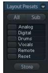
Mit einem einfachen Klick ist es sodann möglich, auf eine Ansicht zu wechseln, welche nur die am Mix der Drum-Sektion, der Bläser oder der Streicher beteiligten Kanäle zeigt – oder jede beliebige andere Ansicht. Ein optimiertes Remote Layout lässt sich hier ebenfalls aktivieren, mit oder ohne visuelle Änderung. Zur Änderung des Namens des Presets genügt ein Doppelklick auf diesen.
