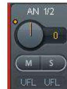
Ein weiterer Unterschied zu den Eingangs- und Playback-Kanälen ist der Taster **Cue** statt Solo. Ein Klick auf Cue schaltet den entsprechenden Hardware Output auf den **Main** Out, oder einen der Phones Outs (Option *Assign / Cue to* in der Control Room Sektion). Damit lässt sich jeder Hardwareausgang bequem über den Monitorausgang kontrollieren und abhören.
