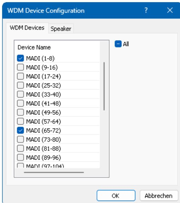
Der Screenshot links zeigt die Multichannel WDM Devices des XT nach Auswahl der Option 'Multi-Channel' im Feld WDM Devices und Klick auf den Knopf *WDM Configure*. In diesem Beispiel sind die Devices *MADI 1 bis 8* und *MADI 65 bis 72* aktiviert.
