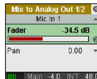
Wie auch bei den anderen drei Tasten bewirkt ein erneuter Druck auf MIX den Wechsel der Anzeige zurück zum Global Level Meter, der alle Eingänge, Ausgänge und FX Send/Return Pegel, das DSP Load Meter, den aktuellen Interface Modus, den Status aller 5 digitalen Eingänge und den MIDI Status anzeigt.
