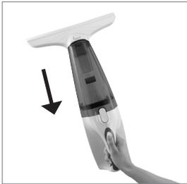
3. Passez le suceur (4) sur la surface à nettoyer du haut vers le bas. Contrôlez durant l'utilisation si le bac de récupération (5) est plein. Si tel est le cas, il doit être vidé.
