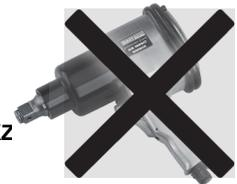
Das empfohlene maximale Schraubdrehmoment beträgt 170 Nm (M18x1,5), 155 Nm (M16x1,5), 99 Nm (M14x1,5), 60 Nm (M12x1,5), 33 Nm (M10x1,5).
