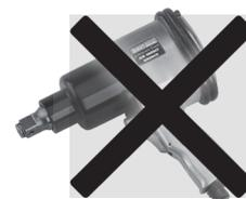
Le torque de serrage maximum recommandé pour les vis de blocage est de 170Nm (M18x1.5), 155Nm (M16x1.5), 99Nm (M14x1.5), 60Nm (M12x1.5), 33Nm (M10x1.5).
