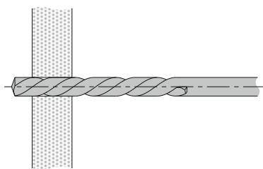
**DE** ACHTUNG! Beim Bohren von Gipskartonwänden Stahlbohrer verwenden!
