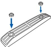
**Montage** Der Adapter lässt sich auf üblichen Gepäckträgern bis 145mm Breite montieren. Muttern in die Befestigungsbrücken eindrücken. Adapter mit der roten Taste nach vorn auf den Gepäckträger setzen. Position so wählen, dass bei aufgesetztem Zubehör genügend Abstand zu Sattel und Pedal bleibt.
