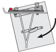
**Utilisation** Paniers et Top Case sont positionés sur la partie supérieure de l'adaptateur. Les sacoches se fixent sur les côtés. Placer les accessoires sur l'adaptateur et pousser vers l'avant. Le système se verrouille automatiquement. Débloquer par simple pression du bouton et pousser les accessoires vers l'arrière.
