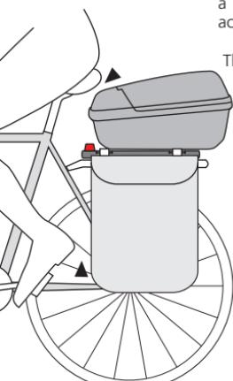
Selon le ou les accessoires qui seront fixés dessus, l'adaptateur devra être fixé sur le porte bagages de telle sorte que leur manipulation soit aisée, et n'entre pas les mouvements du cycliste et que leur avancée n'accroche pas la selle. Retirer au besoin le tendeur de porte-bagages. Fixer l'adaptateur avec une des barres de fixation à l'avant et la seconde à l'arrière. 2 positions sont possibles. Serrez les vis jusqu'à ce que la plaque ne bouge plus (1,5-2 Nm).
