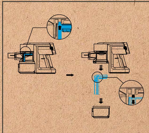
Beutelhalterung inkl. Filter in den Handsauger einsetzen.
