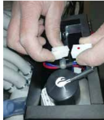
3. Schritt: Weisse Verbindungsstücke entkuppeln
