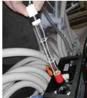
5. Schritt: UV Licht zum Wechslen rausnehmen
