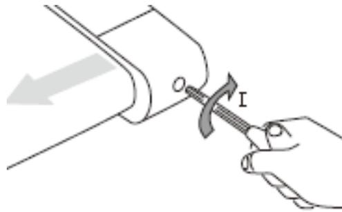
2. Wenn der Laufriemen in der Nähe der linken Seite mit einem Schraubenschlüssel rechts von der Einstellschraube gegen den Uhrzeigersinn gedreht wird, bis der Laufriemen zentriert werden kann (wenn nötig, können Sie die Schrauben gleichzeitig einstellen)
