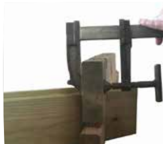
Redirected board • Tabla redirigida • Madrier redressé • neu ausgerichtetes Brett • Tavola riposizionata • Rechtgebogen plank • Tábua redirigida
