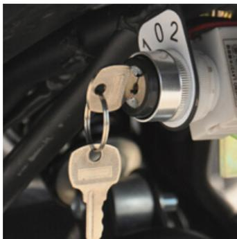
Der 3-stufige Geschwindigkeitsregler befindet sich rechts unter dem Sitz (siehe Abbildung). 0 ist die niedrigste Stufe, 1 die mittlere Stufe, und 2 die höchste Geschwindigkeitsstufe.
