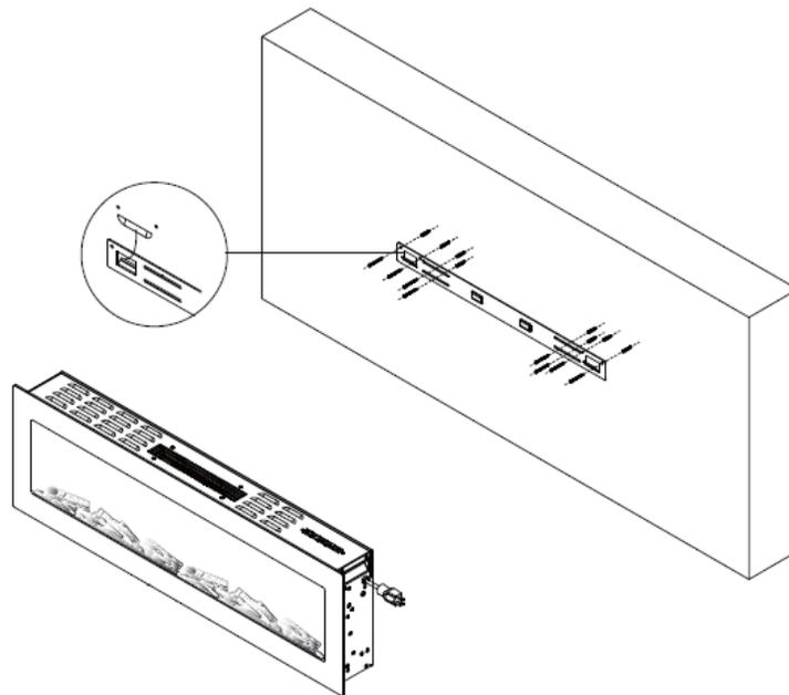
Vorsicht: Es wird empfohlen, die Halterung C mit Wandankern in die Wand zu schrauben, sollte die nicht möglich sein, verwenden Sie die befügten Plastikdübel und machen Sie sicher das die Halterung sehr gut befestigt ist.
