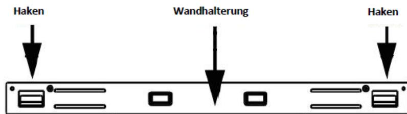
A. Halten Sie die Halterung an die Wand und markieren Sie die 8 Schrauben Löcher. Machen Sie sicher,dass
