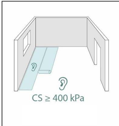
Bitte verwenden Sie eine geeignete Trittschallunterlage für Vinylböden mit einer Druckbeanspruchung von mind. 400 kPa. Wenn es die Verlegung erforderlich macht, vergessen Sie nicht eine Dampfsperre zu verwenden.
