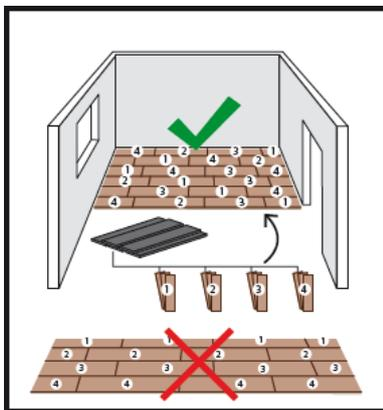
Prüfen Sie vor der Verlegung die einzelnen Dielen auf Farbe und Struktur. Wir empfehlen mehrere Pakete zu mischen, um ein gleichmäßiges Verlege- / Sortierbild zu erhalten.
