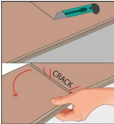
Die Kürzung der jeweiligen Paneele auf Maß können Sie mit Hilfe eines Winkels und einem Teppichmesser vornehmen. Anschließend können Sie das Paneel über „die Kante brechen“.
