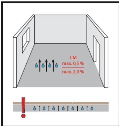
Überprüfen Sie die Feuchtigkeit des Unterbodens. Die maximal zulässige Feuchte bei Zementstrich liegt bei 2,0%, bei Fußbodenheizung 1,8%. Bei Anhydrit-(Calziumsulfat)-Estrich liegt die maximale Restfeuchte bei 0,5%, bei Fußbodenheizung max. 0,3%.
