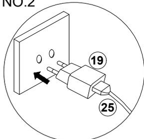
Stecken Sie das 25te Netzkabel in den 19ten Stecker und schließen Sie dann das Netzteil an
