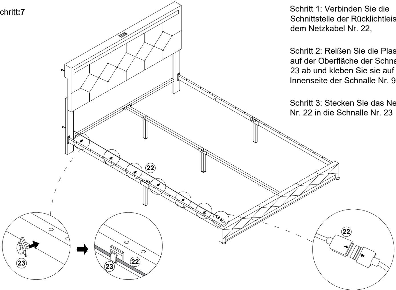
Schritt 1: Verbinden Sie die Schnittstelle der Rücklichtleiste mit dem Netzkabel Nr. 22,
