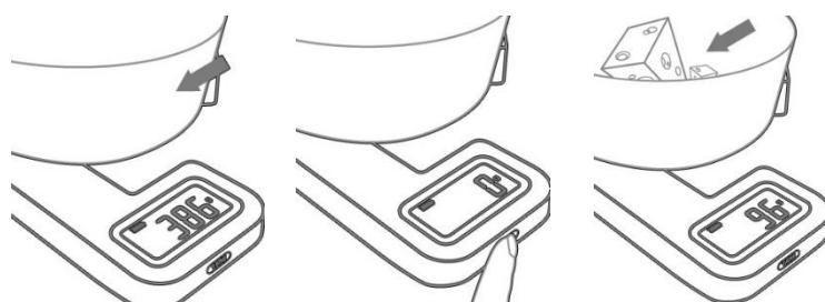
Coloque un recipiente sobre la superficie de la báscula. El display muestra el peso del recipiente.
