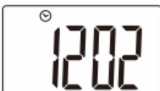
Abbildung 3: Im Schlafmodus zeigt die LCD-Anzeige nur die Uhrzeit
