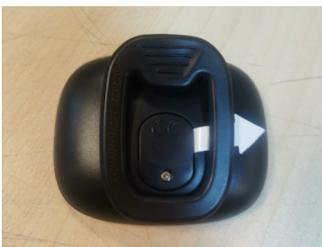
Lösen Sie die Schraube mit einem Schraubenzieher, öffnen Sie das Gehäuse, nehmen Sie die Batterie heraus und ersetzen Sie sie. (Die beschriftete Seite muss nach oben zeigen.)
