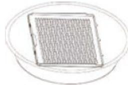
Hinweis: Um eine Verformung des Filters zu verhindern, muss er auf natürliche Weise getrocknet werden.
