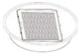
Remarque : Pour éviter la déformation du filtre, il doit être séché naturellement.
