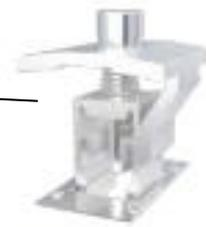
3.3.3 Schieben Sie dann das andere Solarmodul an die Seite des zuvor installierten Solarmoduls und ziehen Sie das Mittelklemmen-Set fest (empfohlener Drehmoment: 10-12 N·m). Bitte beachten Sie, dass das Antirutschmittel Das Schutzgerät sollte sich in der Mitte der Nut der unteren Reihe von Schienen befinden. Siehe rechts.
