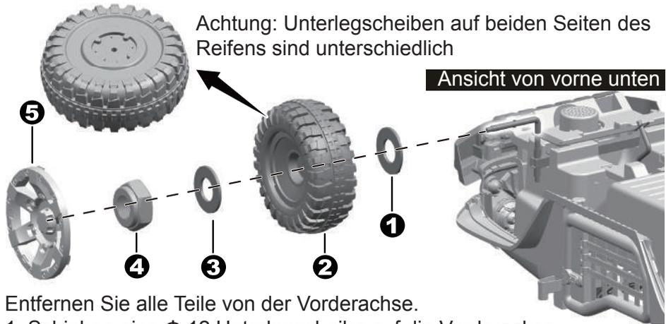
Entfernen Sie alle Teile von der Vorderachse.
