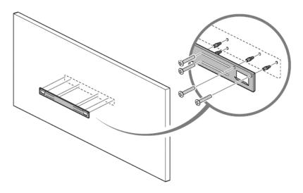
3. Heben Sie nun vorsichtig das Produkt an (hierfür wird eine zweite Person als Hilfe empfohlen) und hängen Sie dieses in die Montageleiste ein. Prüfen Sie sorgfältig den korrekten und sicheren Sitz des Produkts und lassen Sie ggf. eine zweite Person das Produkt stützen, bis die Wandmontage vollständig abgeschlossen ist.
