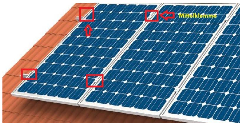
Info: Die Module sollten oben und unten 20-30cm über die Schienen hinaussehen. Beachten Sie dies bei der Anbringung der Dachhaken (abmessen)
