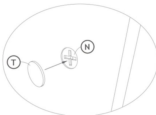
NACHDEM DEM AUFBAU KLEBEN SIE MÖBELGLEITER (T) AUF DIE VERBINDUNGSTÜCKE (N), UM SIE ZU BEDECKEN.
