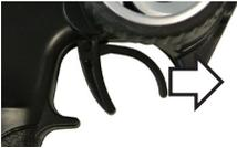
→ Wechseln Sie nicht sofort zwischen den Fahrrichtungen, sondern stoppen Sie das Fahrzeug zuerst, bevor Sie in die jeweils andere Richtung fahren. Ein direkter Wechsel der Fahrrichtung kann zu einer Überlastung des Getriebes führen.
