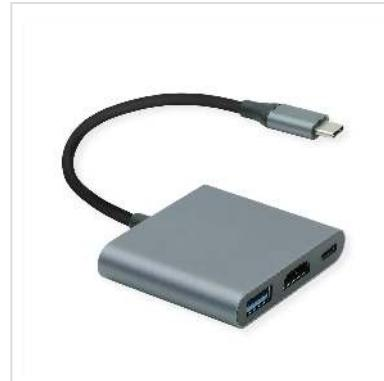
**Verbinden Sie Ihr Macbook, Ultrabook, Notebook/Laptop oder PC mit USB Typ C Schnittstelle mit einem HDMI-Display oder Projektor - mit einer maximalen Auflösung von bis zu 3840x2160 @60Hz! Laden Sie Ihr Gerät gleichzeitig über PD (Power Delivery) auf und schließen Sie eine zusätzliche Peripherie oder ein anderes Gerät wie eine SSD an den zusätzlichen USB Typ A Port an.**
