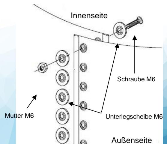
Befestigen Sie die Halterungen der Stützpfostenabdeckungen vor der Montage. Schrauben Sie die Pfosten im unteren Bereich mit 2 Schrauben an ihrem Verbindungsstück fest und befestigen Sie dann die Pfosten im oberen Bereich mit 2 Schrauben an ihrem Verbindungsstück, wobei die beiden Schrauben noch nicht angezogen werden dürfen.
