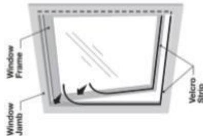
**Schritt 2:** Bringen Sie die Fensterabdichtung an, Klettband an, stellen Sie sicher, dass zwischen dem Fensterrahmen und der Fensterdichtung kein Luftspalt für den Luftausritt vorhanden ist. Die Reißverschlussöffnung an der Fensterdichtung muss sich dort befinden, wo der ausziehbare Hausauslass der Klimaanlage sie leicht erreichen kann. Öffnen Sie den Reißverschluss, damit der Auslass angebracht werden kann und schließen Sie ihn fest, um den Auslass an Ort und Stelle zu halten.
