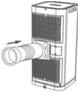
**Schritt 4:** Passen Sie die Länge des flexiblen Abgasschlauches an und vermeiden Sie Knicke im Schlauch. Platzieren Sie das Gerät in der Nähe einer Steckdose.
