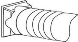
**Schritt 2:** Verbinden Sie den Adapter des Fenstersatzes mit dem anderen Ende des Abgasschlauches.
