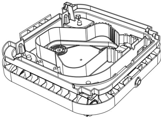
Das Gerät stoppt automatisch und die LED- Anzeige zeigt den Fehlercode E4 an, wenn der Wasserbehälter voll ist. Sie können den Wasserstopfen herausnehmen und das Gerät kippen, dann fließt das Wasser heraus.
