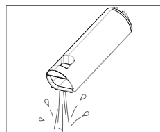
Fig. 10 – Svuotamento del serbatoio dell'acqua
